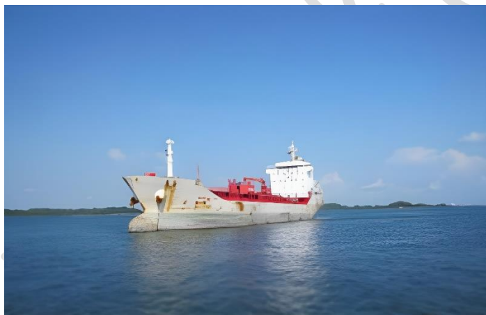
图二：船舶在锚地处于压载状态
